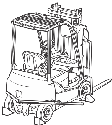
Points d'arrimage de la barre d'attelage des versions à quatre roues
